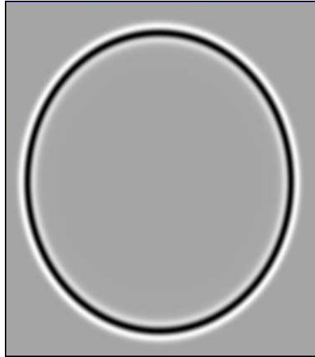
Figura 5: Instantâneo de uma propagação de campo de ondas em um modelo de velocidades homogêneo. A fonte se encontra no centro da imagem.
