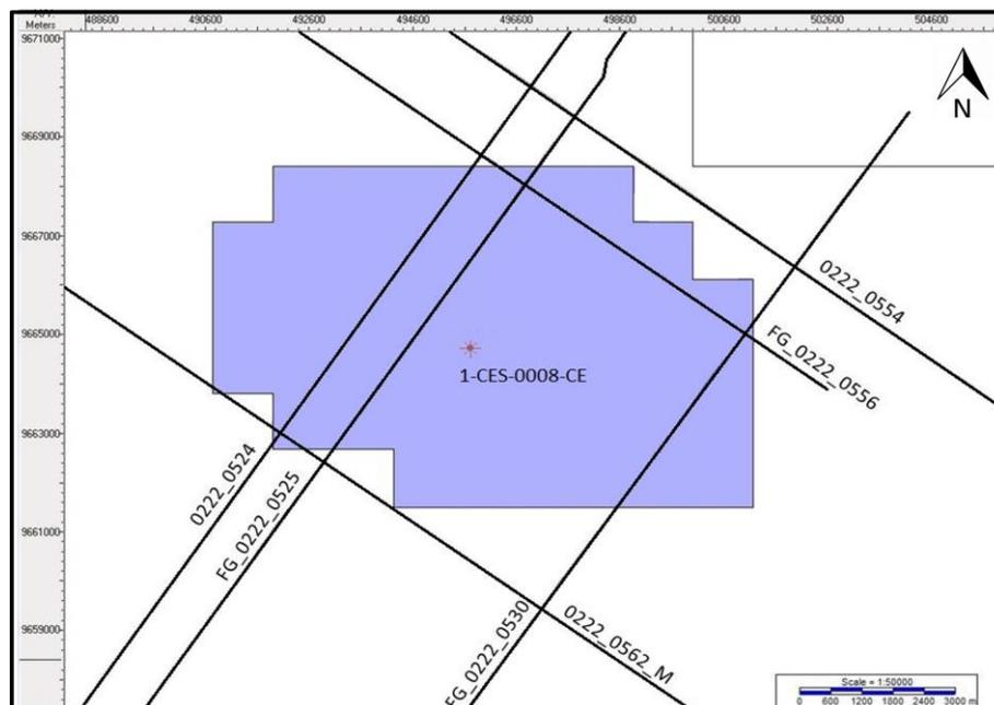
Figura 26 - Aproximação da área do Campo de Xaréu (azul) com identificação do poço (laranja) e das linhas sísmicas de reflexão 2D (preto) utilizados no projeto.
