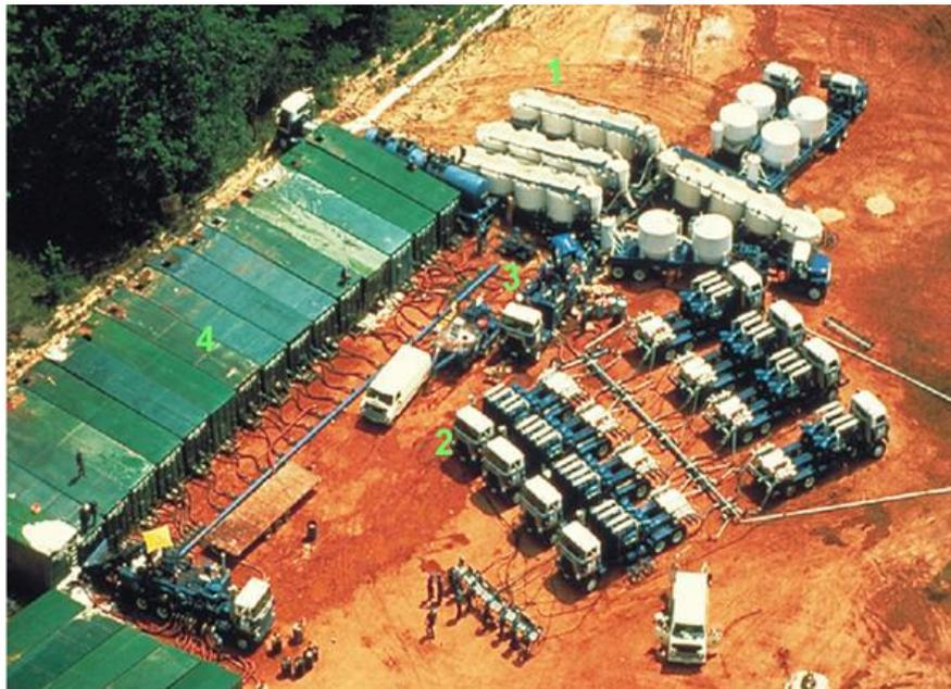
Figura 6.13: Exemplo de equipamentos utilizados em um fraturamento hidráulico.1) Silos propante; 2)Unidades de bombeio; 3)Unidade de mistura; 4) Tanques com gel e água. Fonte: Virgens, 2011.
