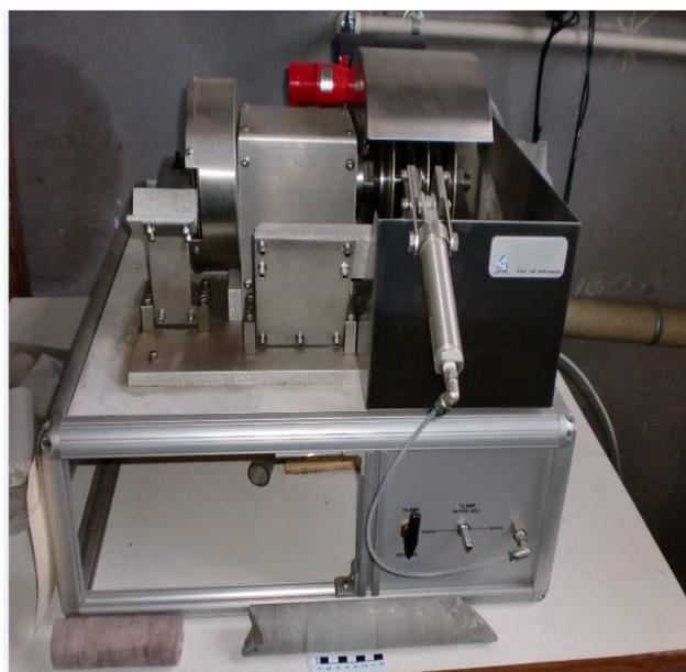
Figura 3.5 - Máquina Faceadeira, (Marca Core Lab). (Pertencente ao LabPetrON).
