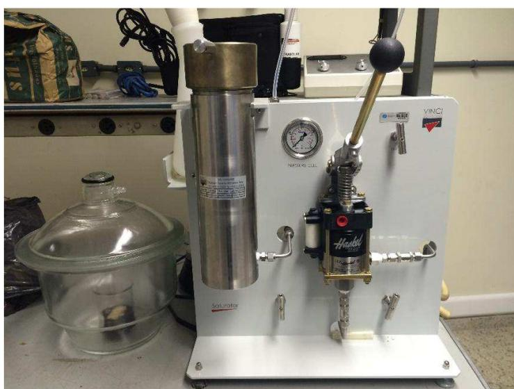
Figura 3.10 – Bancada com o dissecador e o saturador manual da marca Vinci (Pertencente ao LabPetrON)
