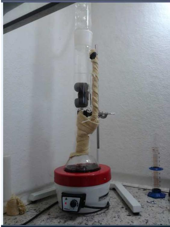
Figura 3.7. Extração contínua via Soxhlet. (Pertencente ao LabPetrON).
