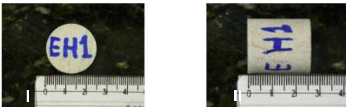
Figura 4.11 - Plugue AV1 utilizado nos ensaios de caracterização – Imagem do topo (I) e lateral (II).
