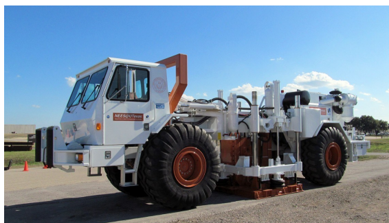
Figura 1 – Fonte sísmica utilizada em aquisições terrestres. Página da Cornell Sun . Acesso: Fev.2019
