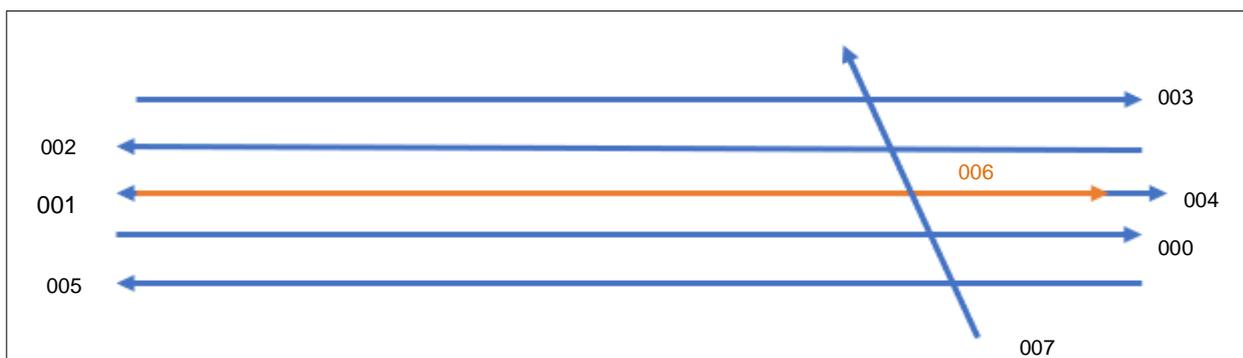
Figura 22 - Representação das 8 linhas levantadas. A fiada de cor diferente foi realizada a uma velocidade de 2 nós enquanto as demais foram realizadas à 4 nós.
