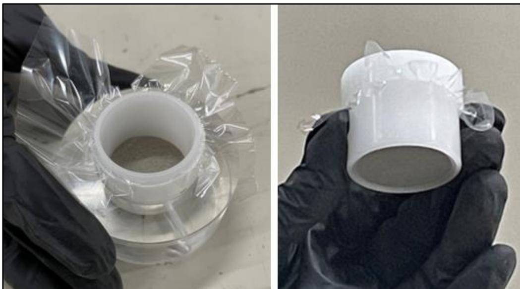
**Figura 21:** Capsulas de plástico utilizados para as análises químicas de XRF. A base do recipiente é o contato entre a amostra e o leitor do equipamento.
