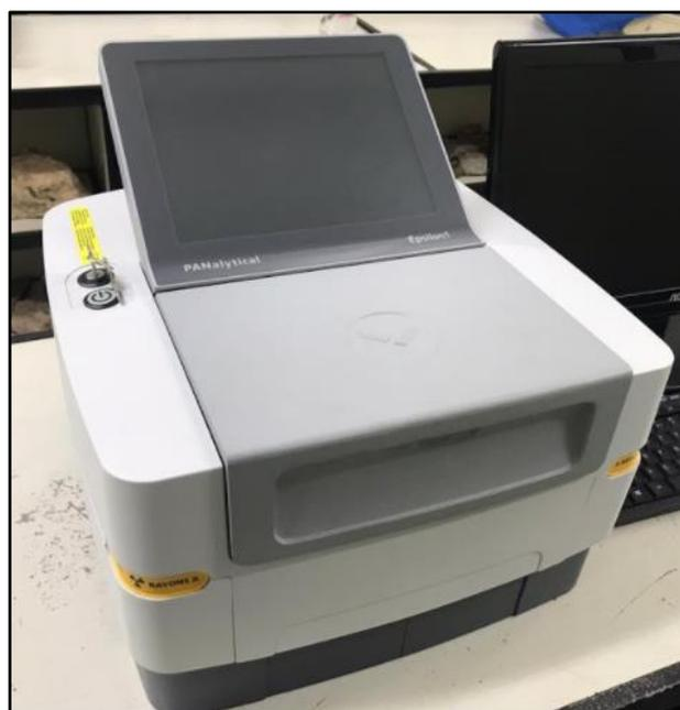
**Figura 22:** Foto do equipamento de Fluorescência de Raio-X utilizado para leitura química elementar das amostras de calha.
