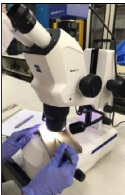
**Figura 17:** Estereoscópio – *Stemi 508*, utilizado para descrição das amostras de calha.
