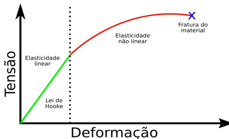
Figura 13 – Relação entre tensão e deformação. Lei de Hooke válida somente até o limite da elasticidade linear (adaptado de Kearey, Brooks e Hill (2013)).
