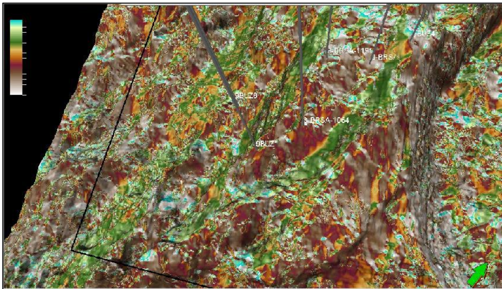
Figura 97: Mesma camada do modelo mostrado na figura 96 anterior, porém agora com um atributo de cor, que busca azimutes preferenciais para diferentes sequências deposicionais.
