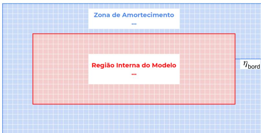
Figura 46 – Ilustração de uma Zona de Amortecimento. Em vermelho é delimitada a região do modelo e em azul a Zona de Amortecimento, a extensão desta zona se dá em função do número de pontos além da malha do modelo  $\eta_{bord}$ . Fonte: O próprio autor.
