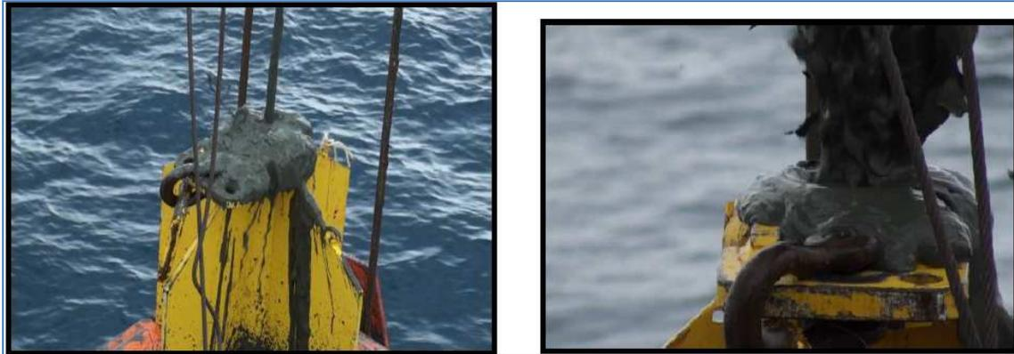
Figura 3.14: Retirada de pistões de amostragem. Chama a atenção o extravazamento dos sedimentos expulsos pelo gás dissociado dos hidratos contidos no pistão. Retirado de (Freire, 2012).
