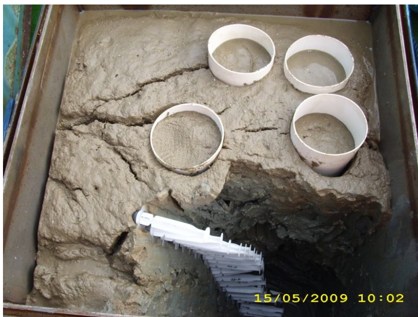
Figura 6: Sub-Amostragem realizada no box-corer, a ser utilizada para ensaios geológicos, geofísicos, geotécnicos e teor de carbonato.
