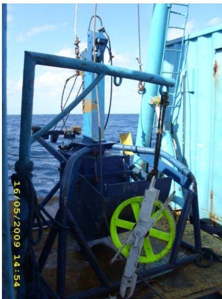
Figura 5: Amostrador box-corer utilizado no trabalho.
