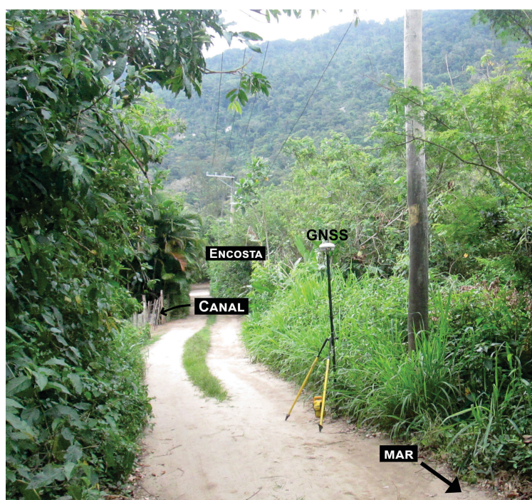
Figura 15 – Equipamento Trimble R8 s em momento de aquisição de pontos de altimetria e localização no local do perfil 4. Fonte: própria
