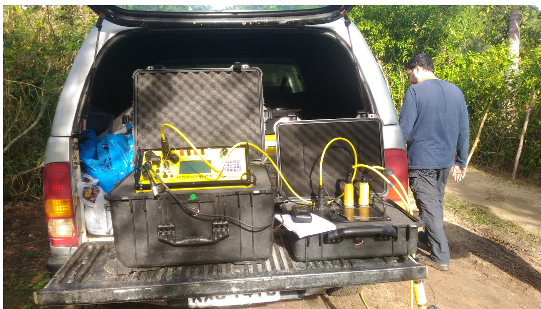
Figura 12 – SuperSting R8/IP da AGI com switch box, utilizado para o levantamento dos dados de eletrorresistividade. No momento deste registro, a aquisição dos dados da linha 4 estava sendo feita. Fonte: própria
