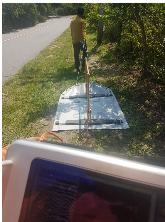
Figura 13 – MALA GPR ProEx System no levantamento de dados da linha 2 no ano de 2018. Fonte: própria
